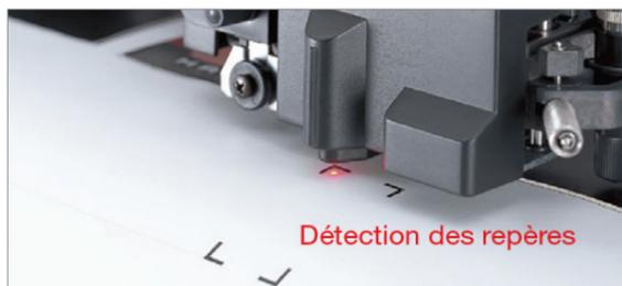
La détection en continu d'un maximum de 4 repères permet de découper les images imbriquées, dans les axes X et Y, avec un alignement automatique.
